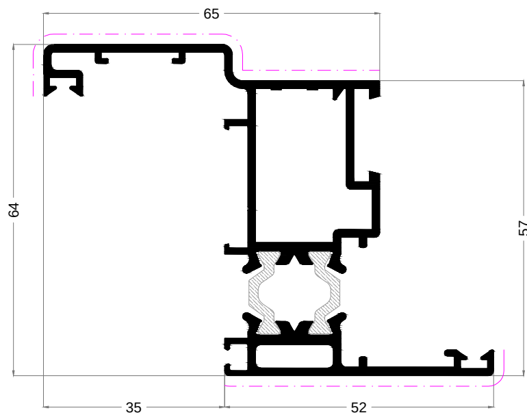
TELAIO Z battuta mm. 35 MX.70.1011 peso kg/ml 1.477 perimetro esterno mm 511.24 perimetro in vista mm 136.91
